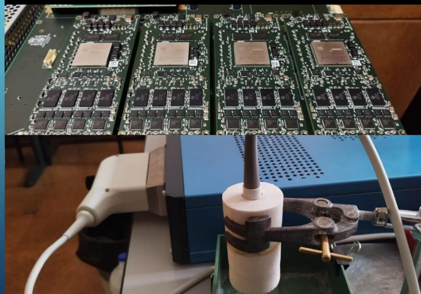
Equipo de imagen multicanal SITA II, con arrays 10MHz y 18MHz
